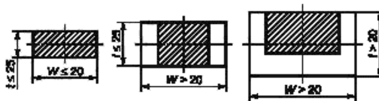
Рисунок ДА.4 — Схема отбора проб от проката прямоугольного сечения
