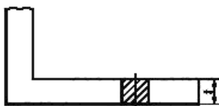
a — Плоский образец на полную толщину профиля при t \leq 50 мм
